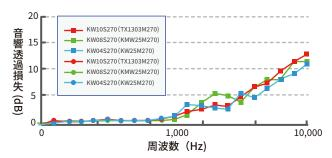
※測定方法 - 内径 15mm 及び内径 100mm の音響管を用いた 垂直入射透過損失測定(ASTM E2611 準拠)
