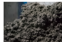
水の浄化の際に汚泥が発生。 これまでは廃棄。
